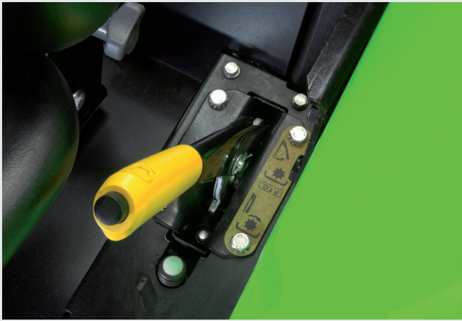
↑ שילוב PTO נוח ועדין תוך שימוש בידית בקרה מכנית. עד לשתי מהירויות PTO (540/540 ECO).
