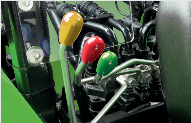
↑ עד שלושה שסתומי בקרה מכניים המוזנים על-ידי משאבת ספיקה קבועה, בעלת ספיקה של 42 ליטר/דקה.
